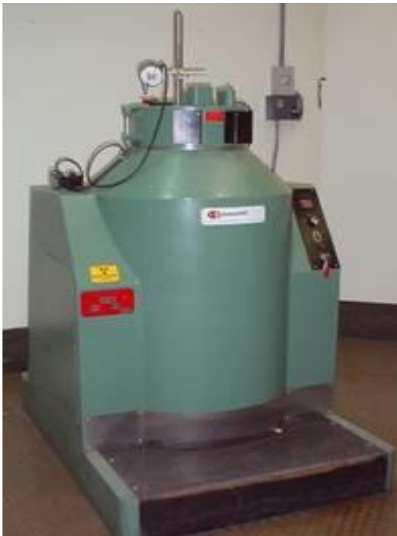
Figura 6. Equipamento irradiador de cobalto-60 ( ^{60}\text{Co} ) é do tipo Gammacell (Atomic Energy of Canada Limited.-modelo 220 número de série 142), utilizado para os tratamentos de irradiação. Laboratório de Fontes Intensas de Radiação (IPEN/CNEN).
