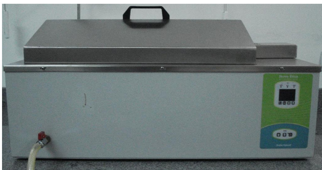
Figura 5. Equipamento de banho-maria Dubnoff, marca Nova Ética, modelo 304 TPA, utilizado para o tratamento hidrotérmico de abóboras Teste hidrotérmico com ovos de Anastrepha grandis “in vitro”
