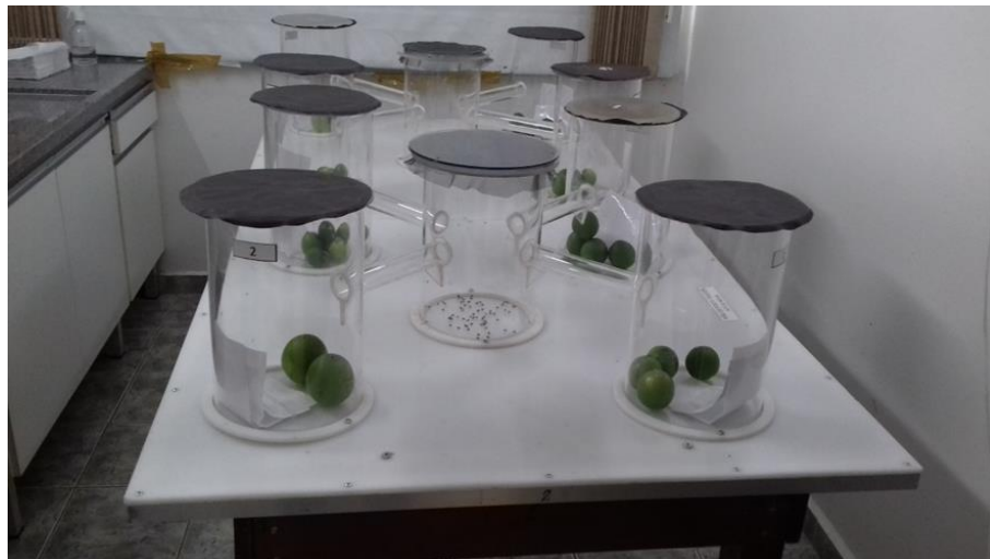
Figura 12 - Olfatômetro de quatro vias usado para avaliar o comportamento de atração de A. fraterculus e C. capitata para os voláteis de laranjas e limas ácidas frescas nos estádios intermediário e maduro. Foto: L. R. F. Louzeiro.
