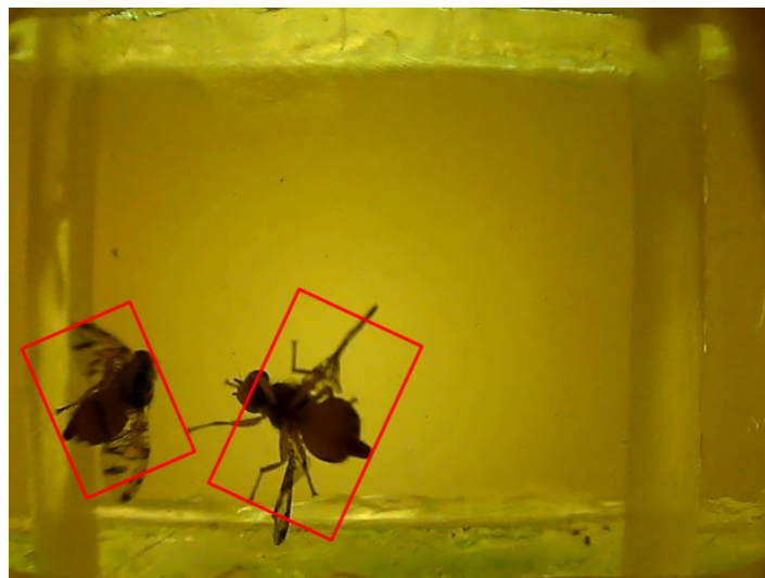
Figura 26- Detecção de movimento das moscas-do-mediterrâneo pelo programa de rastreamento da armadilha automatizada.
