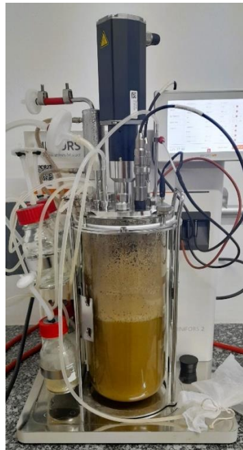
Figura 08 – Biorreatores tipo Stirred Tank Reactor – STR com fermentação do meio T1.S.II-2023 de Metarhizium anisopliae IBCB383. Imagem: Pereira, R.M.C., 2024.
