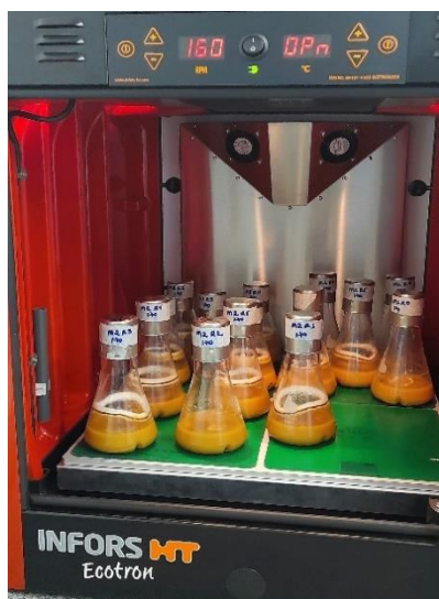
Figura – 78 Inóculos de IBCB170 para a seleção S.II-2023 em processo de fermentação em mesa orbital fechada e controle de temperatura. Imagem: Pereira, R.M.C., 2024.
