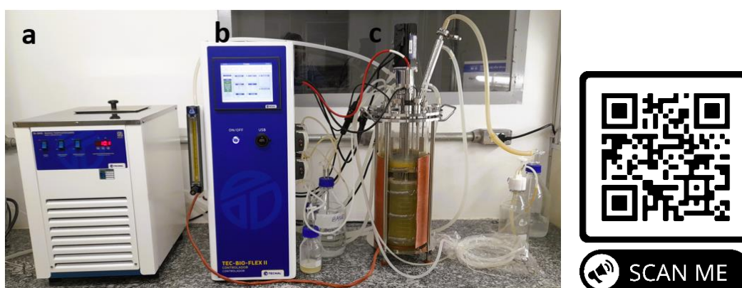
Figura 79 – Biorreator de bancada em processo de fermentação: a) chiller; b) torre de comando; c) vaso com as sondas; QRcode para acesso ao vídeo no Youtube. Imagem e QRcode: Pereira, R.M.C., 2023.
