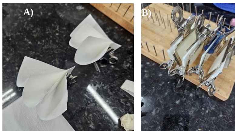
Figura 7. Pacotes impregnados para bioensaio TPL (A) e os pacotes já fechados com cliques (B). Fonte: foto da autora
