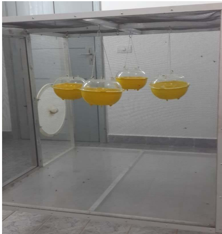
Figura 6 - Gaiolão com armadilhas McPhail utilizado nos experimentos de atrativos de moscas-das-frutas. LEE/CAPPPSA. Campinas, SP.
