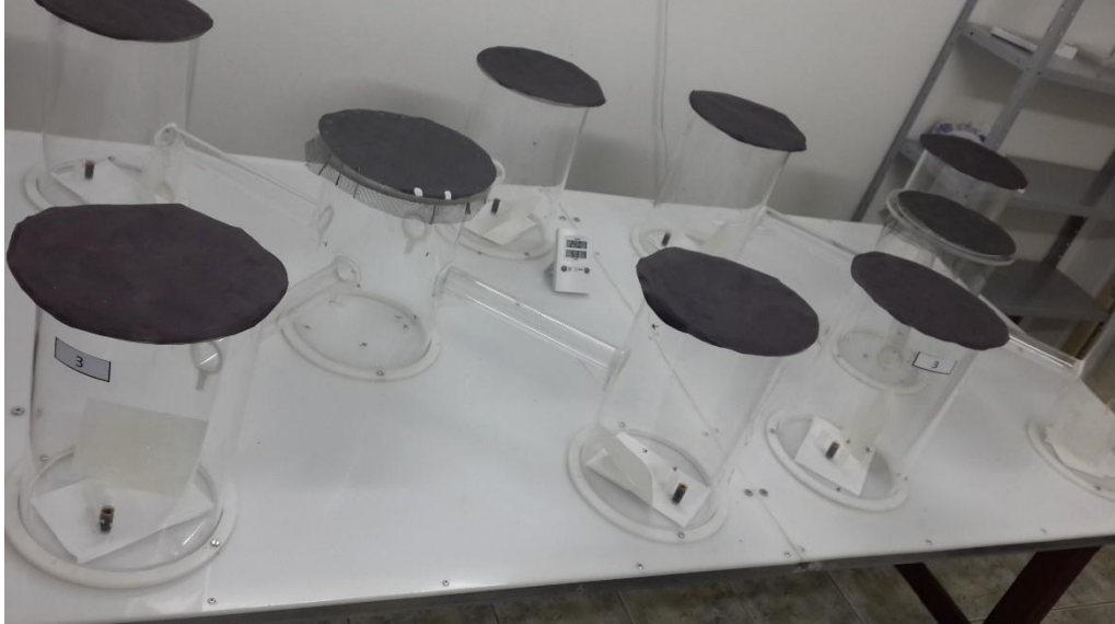
Figura 5 - Olfatômetro utilizado nos experimentos de atrativos de moscas-das-frutas. LEE/CAPPPSA. Campinas, SP.
