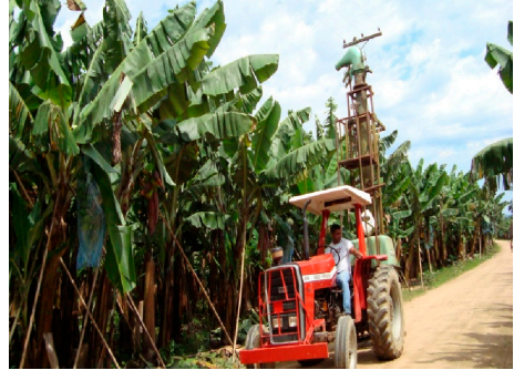
Fig. 12 - Aplicação com pulverizador tipo "canhão", adaptado, para lavoura de banana.
