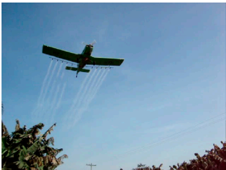
Fig. 9 - Avião Ipanema em aplicação de agroquímicos e equipado com bicos rotativos.
