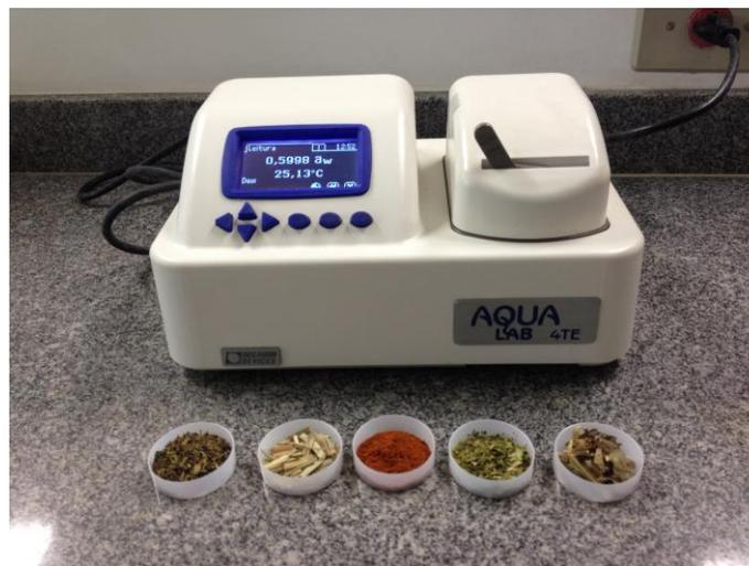
**Figura 5** – Equipamento de medição de Atividade de Água (*Aa*).
