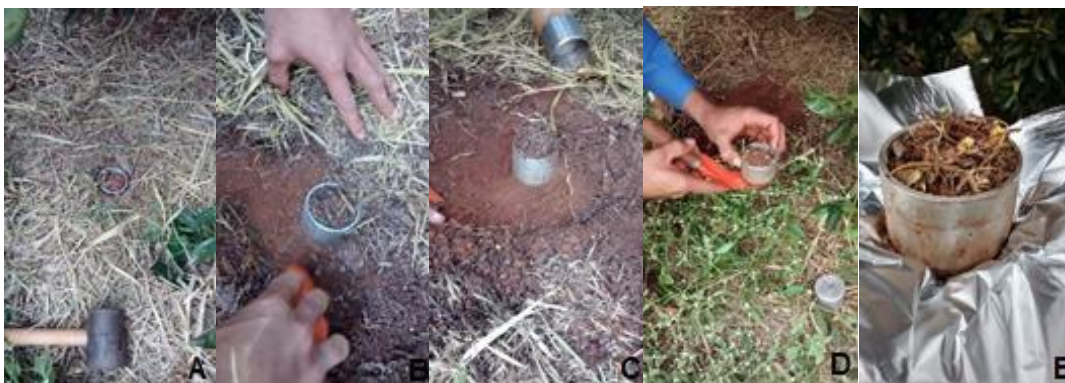
Figura 3. Coleta de amostra de solo. A - introdução do cilindro no solo (Martelo de borracha). B - raspagem do solo envolta do cilindro. C - raspagem finalizada. D - retirada do anel do solo. E - amostra coletada, envolvida em um pedaço de papel alumínio.
