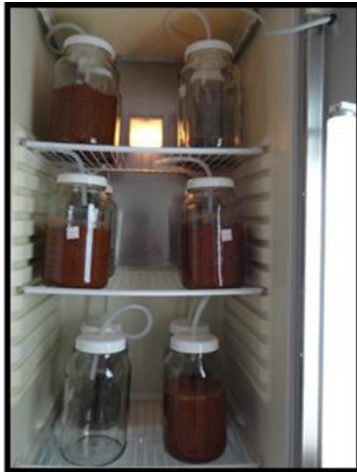
Figura 13: Conjunto de dois recipientes de vidros – o microcosmo, com tampas vazadas permitindo a passagem de uma mangueira de silicone interligando os recipientes de vidros e seus tratamentos. Detalhe do microcosmo mantido dentro de estufa tipo BOD, regulada para as temperaturas de 37\pm 2^{\circ}\text{C} e 23\pm 2^{\circ}\text{C} , visando ao controle do fungo Phaeoconiella chlamydospora , em mudas infectadas da videira 'Niagara Rosada'.
