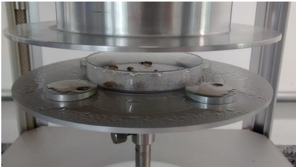
Figura 4. Teste de patogenicidade: Aplicação dos tratamentos em Torre de Potter. Fonte: Arquivo pessoal Isabella Gotti
