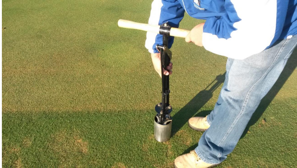
Figura 2. Coleta realizada no perímetro da mancha, com vasador de buracos de campos de golfe
