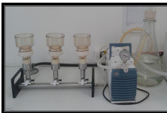
Fotografia 8 - Sistema de filtração tipo manifold
