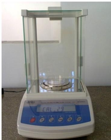
**Figura 4** – Balança analítica modelo AS 220/C/2 Radwag Wagi Elektroniczne CE. Laboratório de Entomologia Econômica, Campinas, 2014.
