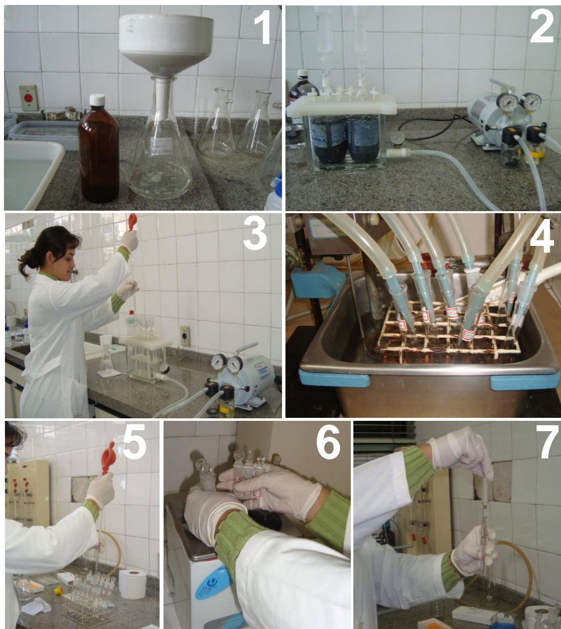
Figura 11: Procedimento de extração em fase sólida (1 – Filtragem da amostra, 2 - Extração dos agrotóxicos, 3 – Eluição dos agrotóxicos, 4 – Concentração da amostragem nitrogênio a 40°C, 5 - Ressuspensão em acetonitrila:metanol, 6 – Homogeneização em ultra-som, 7 – Filtragem a amostra) com amostras de água superficial dos locais analisados. Fotos: K.C.R. Santana e L. Murakami.
